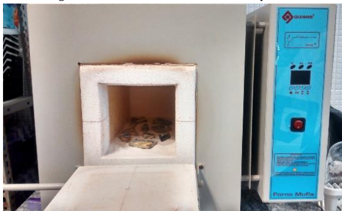
Figura 63 – Fragmentos em forno Mufla, antes da requeima a 1000°C
