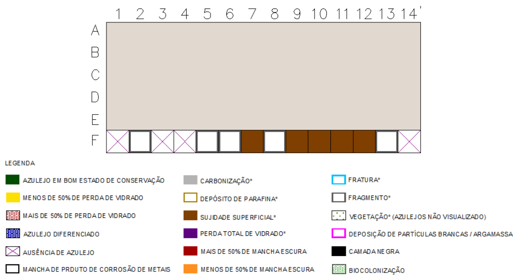
Figura 23 – Mapeamento de danos dos azulejos do painel horizontal da sepultura O12
