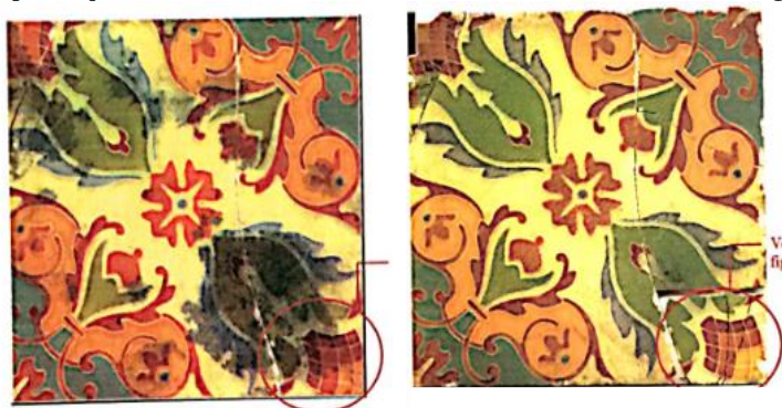
Figura 24 – A) Azulejo antes da queima a 550°C, em que é possível observar a presença de manchas escuras; B) Azulejos após a queima 550°C, com clareamento das manchas de micro-organismos.
