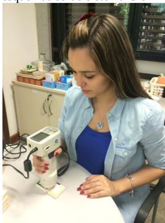
Figura 65 - Procedimento realizado com o colorímetro para classificação da cor e Diagrama esquemático do sistema CieLAB.
