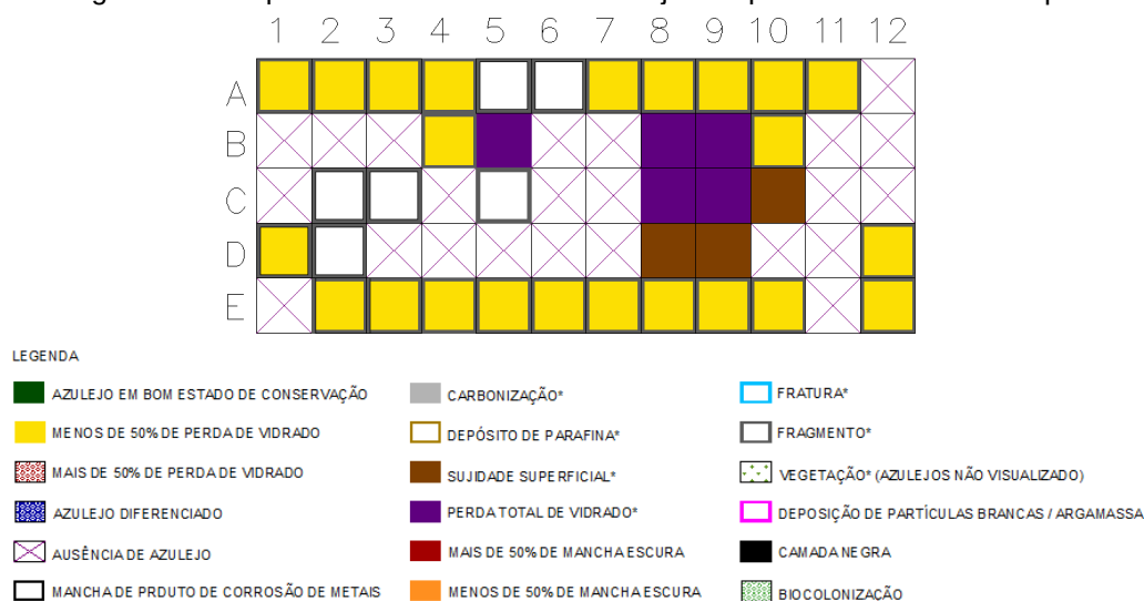
Figura 28 – Mapeamento de danos dos azulejos do painel horizontal da sepultura P3
