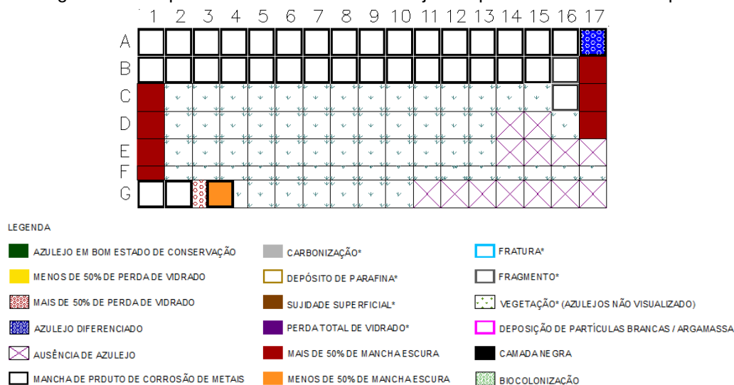
Figura 14 – Mapeamento de danos dos azulejos do painel horizontal da sepultura I14
