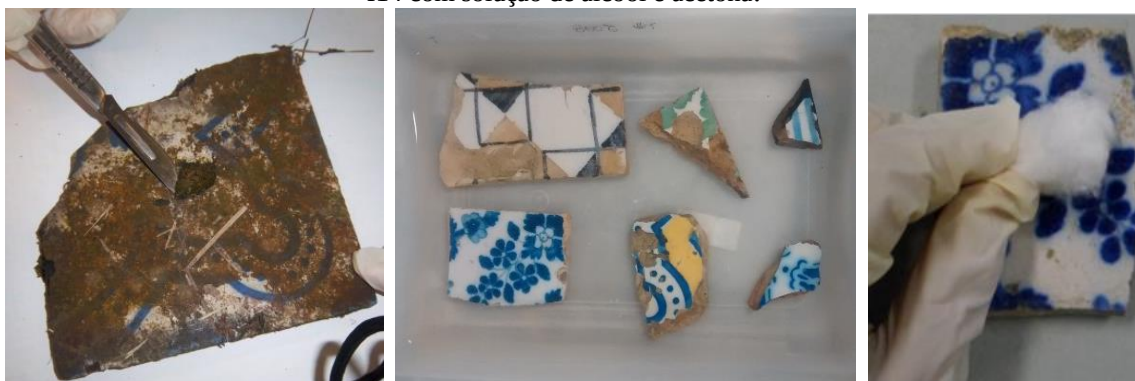
Figura 62 – Amostras imersas em água destilada; B) Limpeza química da face vitrificada da amostra I14 com solução de álcool e acetona.
